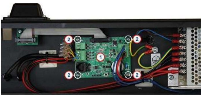
Фиг. 8 Подмяна на FC HUB платка.
